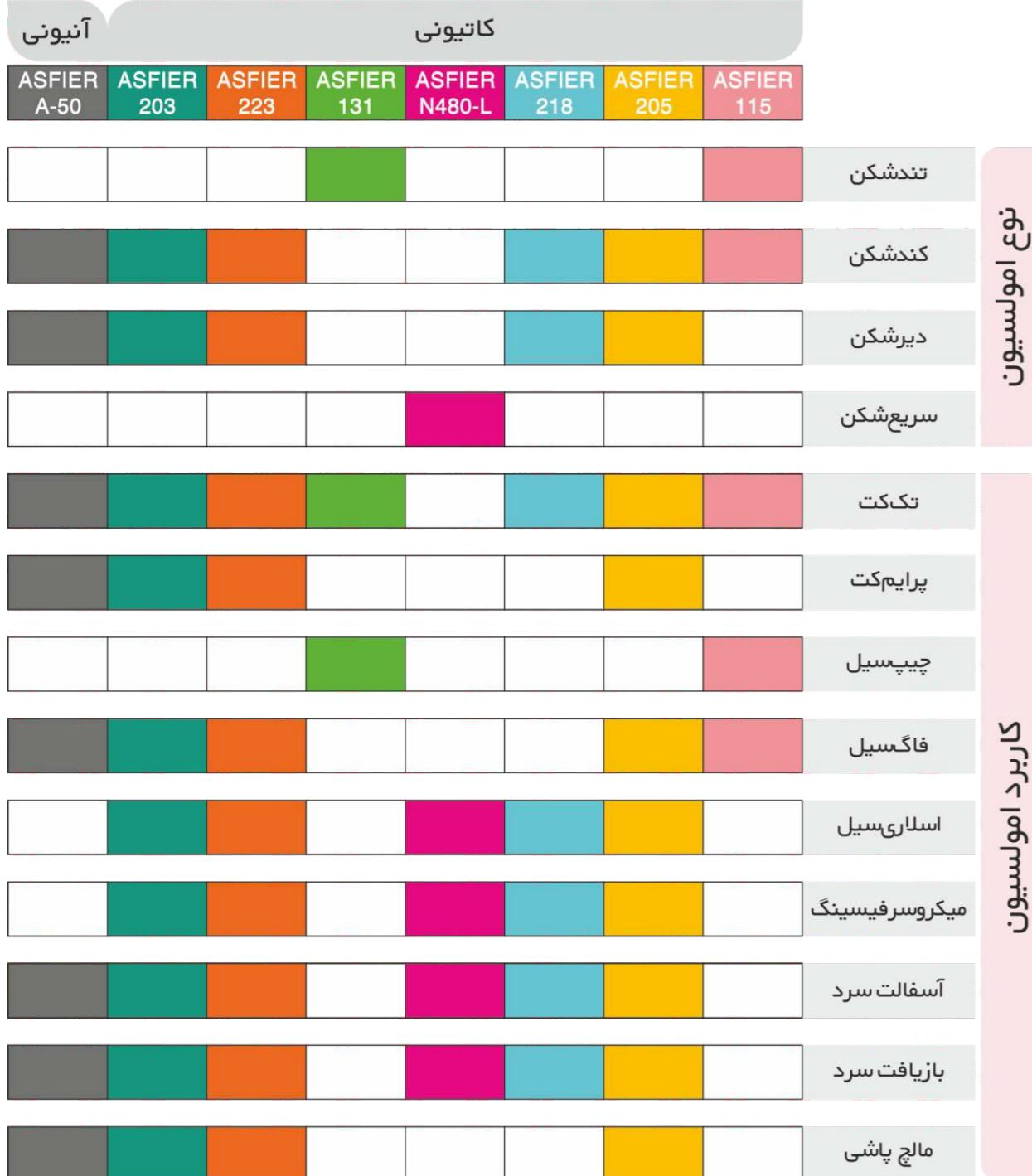
جدول فوق بصورت کلی توانایی ساخت انواع قیر امولسیون توسط انواع امولسیفایرها را نشان می‌دهد اما به صورت خاص با توجه به شرایط تولید و شرایط محیطی پروژه نوع دقیق امولسیفایر مورد نیاز هر پروژه می‌تواند توسط کارشناسان این شرکت تعیین و فرمولاسیون دقیق آن جهت مصرف پیشنهاد گردد.
