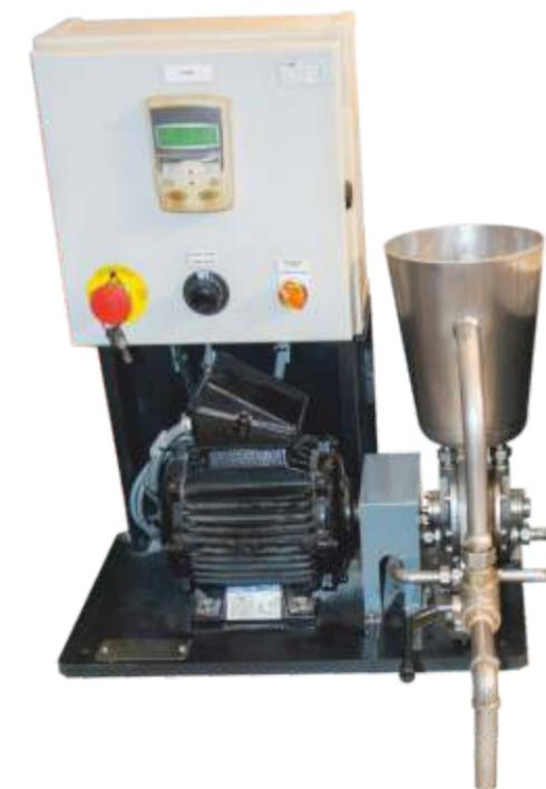
همچنین استفاده از انواع افزودنی‌ها به منظور بهبود مشخصات و عملکرد قیر در صنعت راه‌سازی رواج یافته است. در این مجموعه، ساخت قیر اصلاح شده با مواد پلیمری و افزودنی‌های مختلف با استفاده از میکسر دور تند با High Shear Mixer انجام می‌پذیرد.
