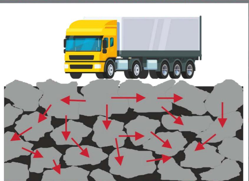
استحکام و ظرفیت باربری بالا در SMA حاصل از تماس یک به یک سنگدانه‌های درشت و اصطکاک داخلی زیاد ناشی از آن است.
